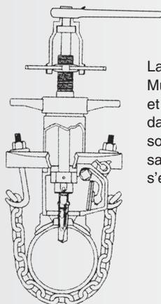
La machine Mueller peut percer et tarauder un trou dans une conduite sous pression sans que l'eau s'échappe.
