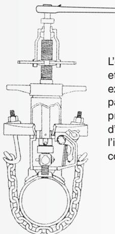
L'outil de perçage et de taraudage est extrait et remplacé par un robinet de prise sur la barre d'alésage pour l'insertion dans la conduite.
