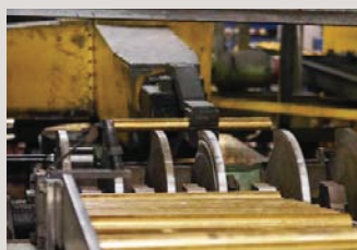
Las barras se cortan en la longitud deseada
