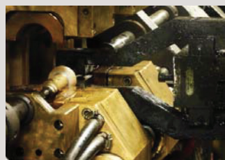
El vástago se calienta eléctricamente y se empuja para crear el collarín de empuje
