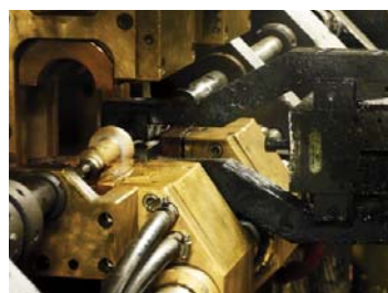
La tige est chauffée électriquement puis poussée afin de créer le collet de butée
